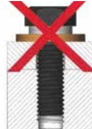
**Keine Sicherungsfunktion in Kombination mit frei rotierender Unterlegscheibe**
