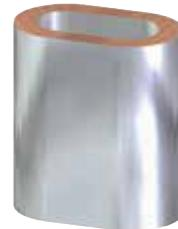
Kupfer-Pressklemmen mit einer verzinkten Oberflächenbeschichtung sehen in Verbindung mit silbernem Drahtseil oder anhängenden Beschlägen nicht nur optisch ansprechender aus (auch nach der Verarbeitung!). Die Beschichtung bewirkt einen zusätzlichen Korrosionsschutz und verhindert die nachträgliche Bildung einer grünlichen Patina bzw. Passivschicht des Kupfers nach Berührung mit leicht aggressiven Laugen und Säuren.
