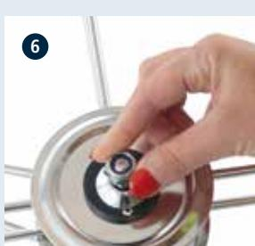
**6 Legen Sie die Distanzscheibe unter die selbstsichernde Mutter und drehen diese fest.**
