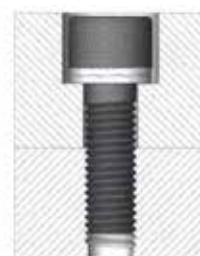
**Zylinderschraube in Senkung gesichert**
