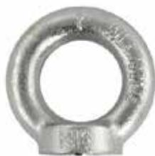
Die Arbeitslast (AL) gilt nur in Axialrichtung und setzt voraus, dass die Ringmutter vollständig aufgeschraubt ist und vollflächig aufliegt.
