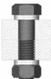
**Sechskantschrauben im Durchgangsschraube beidseitig gesichert**
