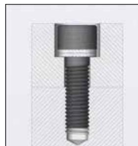
Zylinderschraube in Senkung gesichert
