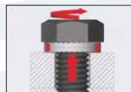
Eine durch Losdrehbewegung verursachte Dickenausdehnung der HEICO-LOCK Keilsicherungsscheiben führt zu erhöhter Klemmkraft. Hierdurch kommt es zur Erhöhung der Vorspannung gegenüber dem Ruhezustand und zur Selbstsicherung der Schraube.
