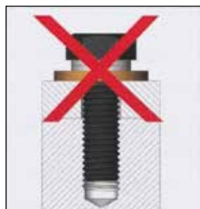
Keine Sicherungsfunktion in Kombination mit frei rotierender Unterlegscheibe.
