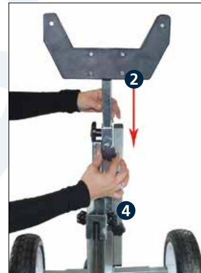
4. Lösen Sie den Motorhalter (2) und schieben Sie diesen in das Grundgestell (4)
