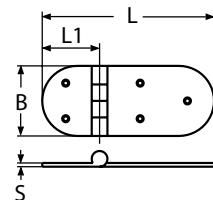
**Scharnier mit Gewinde / A4-AISI 316**
