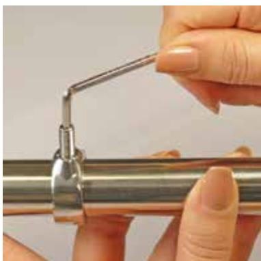
2. Für die Fixierung das Rohr des Spritzkappengestells mit 3mm vorbohren. Dann den Stellring auf das Rohr schieben, in Position bringen und anschließend mit dem Inbusschlüssel anziehen.
