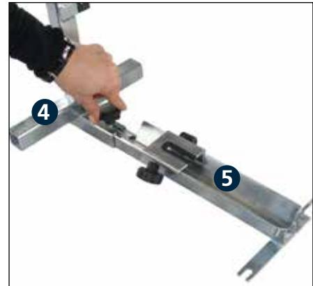
3. Stecken Sie die Führung (5) in das Grundgestell (4) und fixieren ihn.
