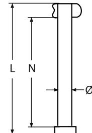
Steckbolzen mit Kugelsicherung / A2-AISI 304
