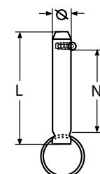
Steckbolzen mit manueller Kugelsicherung / A2-AISI 304
