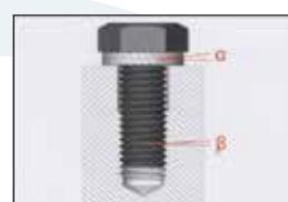
Der Keilwinkel  $\alpha$  zwischen den HEICO-LOCK® Keilsicherungsschrauben ist größer als der Steigungswinkel  $\beta$  des Schraubengewindes. Die Dickenausdehnung der HEICO-LOCK® Keilsicherungsscheiben ist aufgrund der Steigung höher als die mögliche Längsverschiebung der Schraube entlang des Gewindes.
