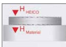
Die Oberflächenhärte der heico-lock® Keilsicherungsscheibe ist im Vergleich zu handelsüblichen Schrauben höher Edelstahl (oberflächengehärtet) > 520 HVO.05
