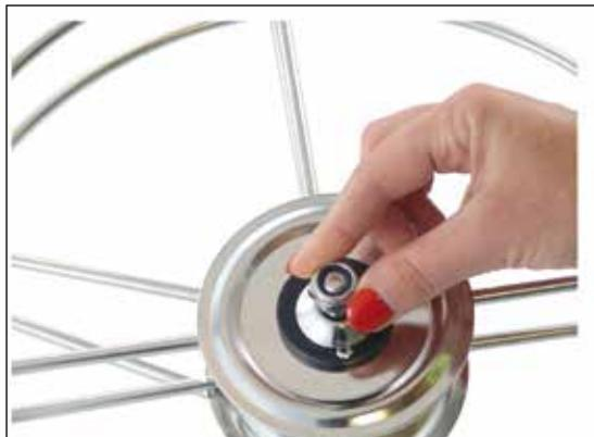
6. Legen Sie die Distanzscheibe unter die selbstsichernde Mutter und drehen diese fest.
