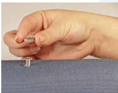
3. Madenschraube des Stellringes durch den Spritzkappenstoff führen und die Dichtscheibe mit der gummiierten Seite nach unten auf den Stoff setzen.
