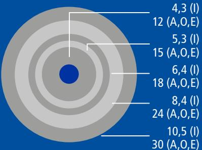
Durchmesser in mm: innen (I) und außen (A)      Diameter in mm: inside (I) and outside (O)
